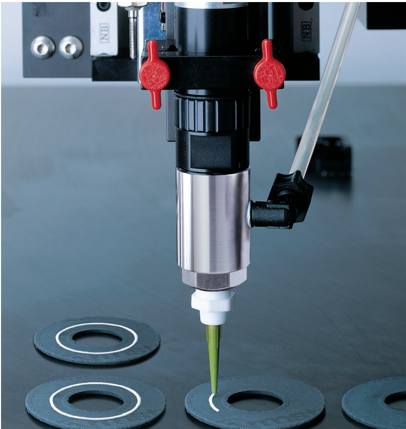
725DA gibt eine gleichmäßige Klebstoffraupe auf Wasserbasis ab.
