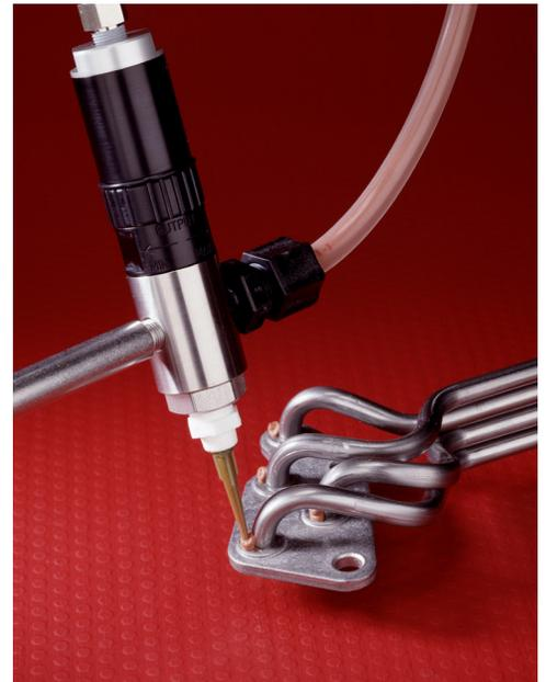
725D dosiert Hartlotpaste auf Kfz-Getrieberohre.
