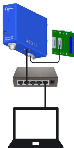
Il controller 7197PCP-DIN consente il controllo delle pompe basato su Internet
