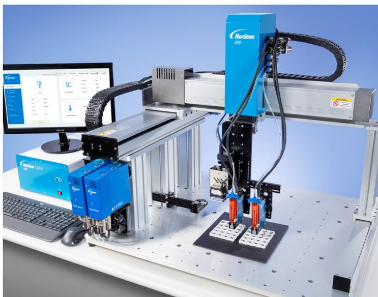
Os aprimoramentos de engenharia na solução GVPlus permitem que o produto ofereça precisão de posicionamento e repetibilidade de colocação de depósito de  $\pm 0,008$  mm / 8  $\mu$ m.
