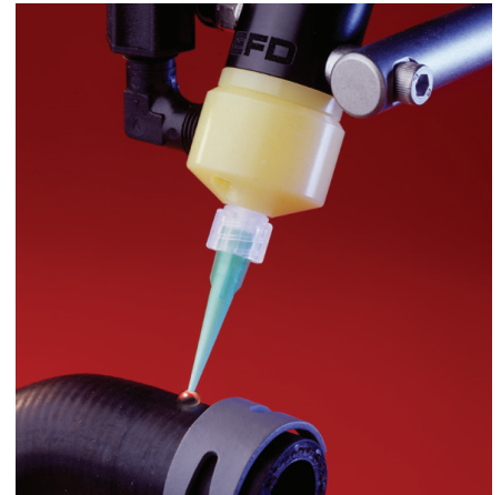
La selección de la punta es fundamental para lograr los mejores resultados en las aplicaciones con cianoacrilatos.
