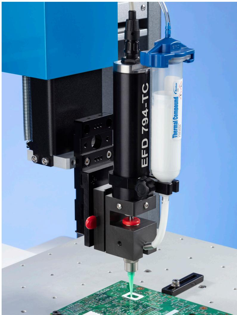
La valvola 794-TC è progettata per applicare depositi precisi e ripetibili di materiale per interfaccia termica.
