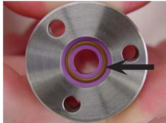
Guarnizione del tappo di uscita (O-ring VISIBILE)
