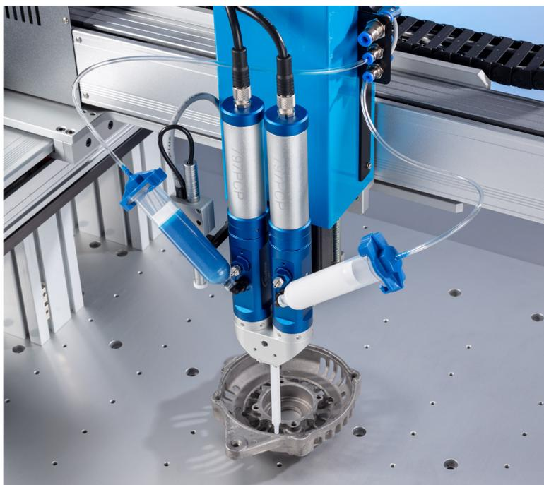
As bombas de cavidade progressiva 797PCP-2K asseguram a melhor precisão de volume de depósito e repetibilidade na dosificação de fluidos em duas partes.
