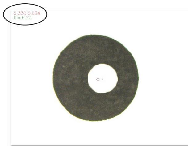
Position der Durchmesser- und Offsetangaben im Bild eines Punktes, der eine Positionsprüfung **NICHT BESTANDEN** hat
