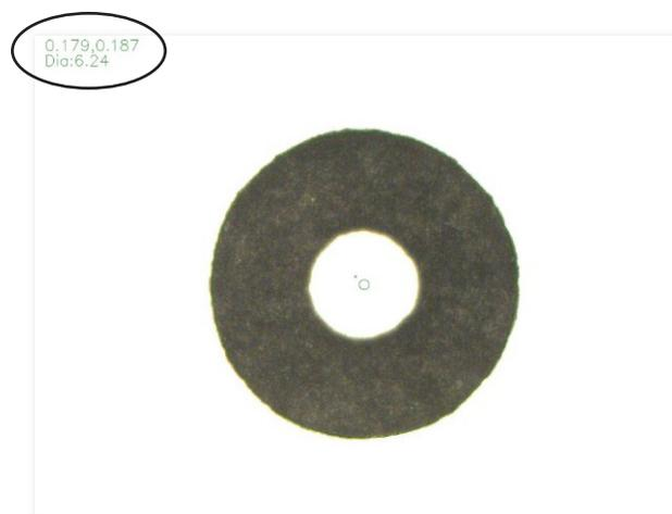
Position der Durchmesser- und Offsetangaben im Bild eines Punktes, der eine Positionsprüfung **BESTANDEN** hat
