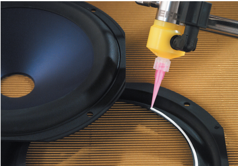
Válvula de diafragma 752 dosificando un cordón adhesivo en los componentes del altavoz.
