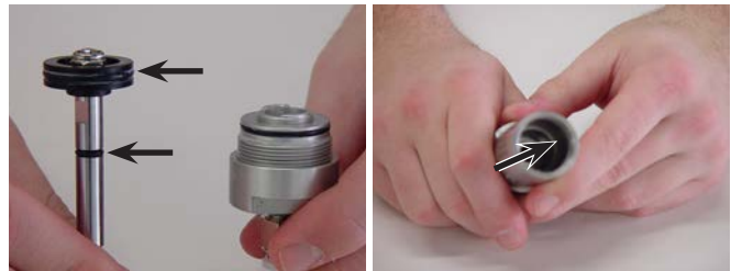
Sello de tapa de salida (junta tórica VISIBLE)
