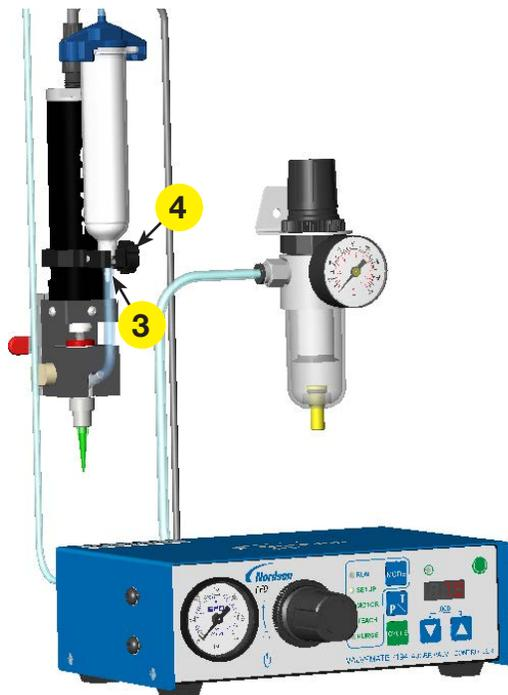
5. Verwenden Sie das mitgelieferte 4 mm Schnellsteckfitting und den 3/32" x 5/32" Materialschlauch um die Materialversorgung mit dem Materialeingang des Spindelventils zu verbinden.
