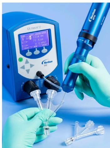
Dépose d'adhésif sur des dispositifs médicaux à l'aide de l'outil HPx™.
