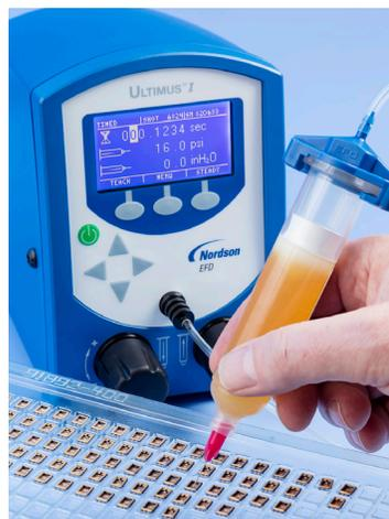
Dépose de flux sur des composants électroniques.
