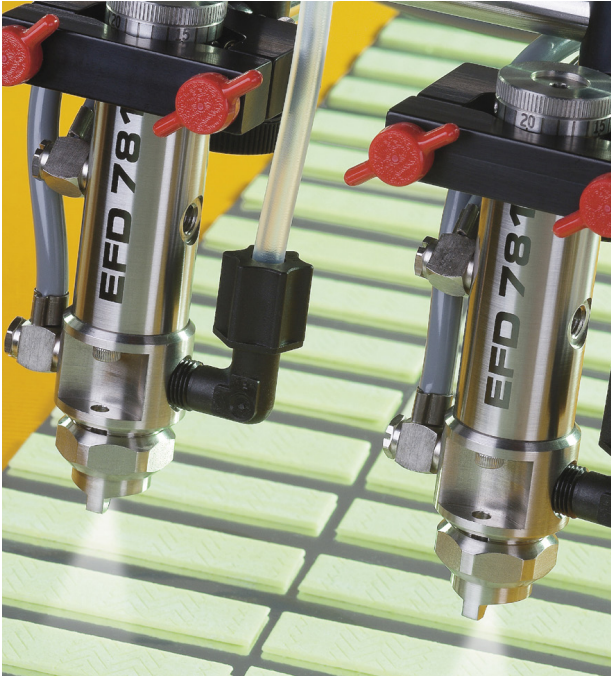
Valvola di spruzzatura 781 applica zucchero su gomma da masticare.
