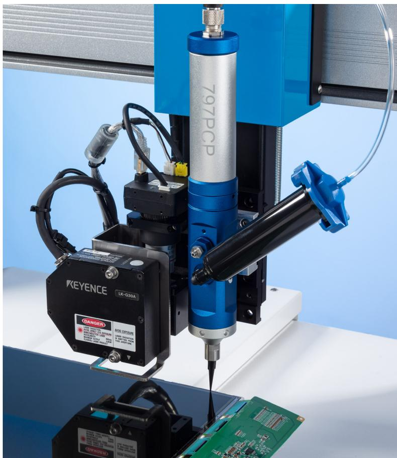
La pompa a cavità progressiva 797PCP offre un livello di accuratezza molto elevato e ripetibilità del  $\pm 1\%$ .
