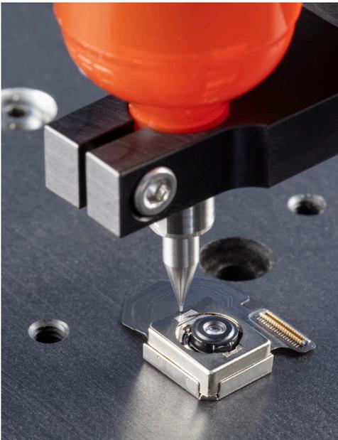
Mikro-Dosierung auf einem Kompaktkameramodul.
