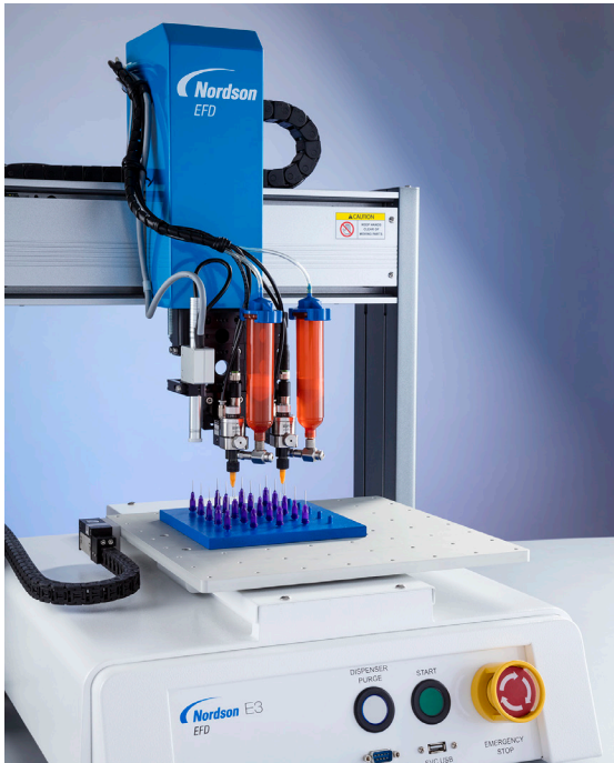
Un robot Serie EV applica materiale a polimerizzazione UV su componenti medicali.
