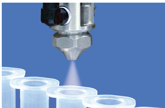
Le valvole di spruzzatura 781S utilizzano la tecnologia LVLP (basso volume, bassa pressione) per applicare un rivestimento sottile di olio silicone all'interno di siringhe per uso medico
