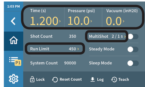
Réglages modifiables sur l'écran Home (Accueil) : Temps, Pression, Venturi, Limite des cycles, et MultiShot
