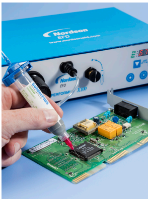
Dosificação de pastas de solda SolderPlus® em placas PCB.
