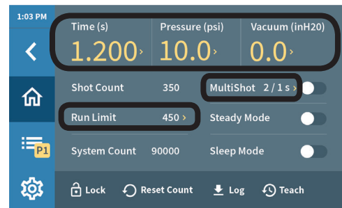
Impostazioni modificabili sulla schermata Home: Time (Tempo), Pressure (Pressione), Vacuum (Vuoto), Run Limit (Limiti corsa) e MultiShot (Depositi multipli)
