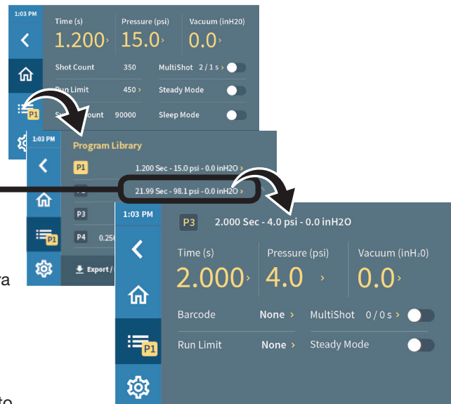
Modifica del Programma 3 (P3) nella schermata Dettagli programma mentre il Programma 1 (P1) è ancora il programma attivo
