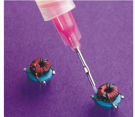
Les aiguilles doublées de PTFE empêchent le bouchage et sont dotées d'une compression qui permet de contrôler le flux des cyanoacrylates liquides.
