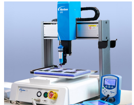
Pour un placement plus précis de cyano, utiliser un système de dosage automatisé.
