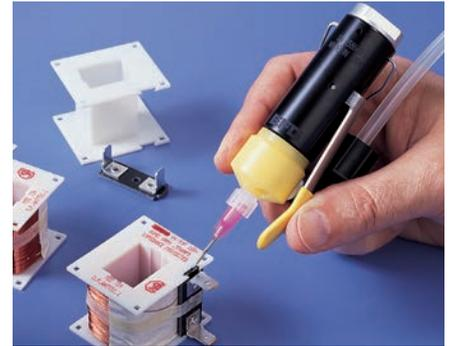
Les pièces en contact avec le fluide de la valve manuelle 752V sont fabriquées en polyéthylène UHMW, ce qui en fait un choix idéal pour la dépose des cyanoacrylates dans les process de production à faible volume.
