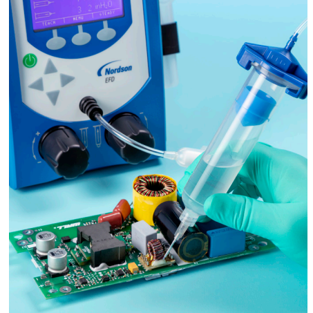
Le doseur Ultimus II offre le meilleur contrôle lors de la dépose de cyanoacrylates aqueux.
