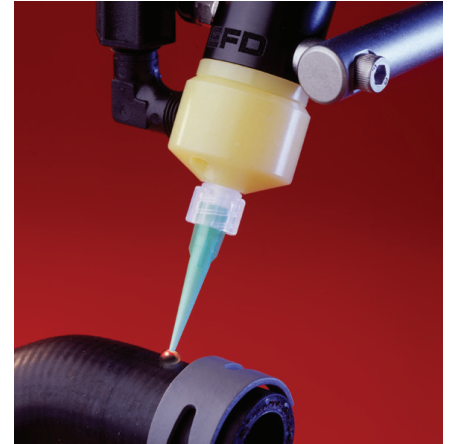
Le choix des aiguilles est essentiel au succès des applications de cyanoacrylates.
