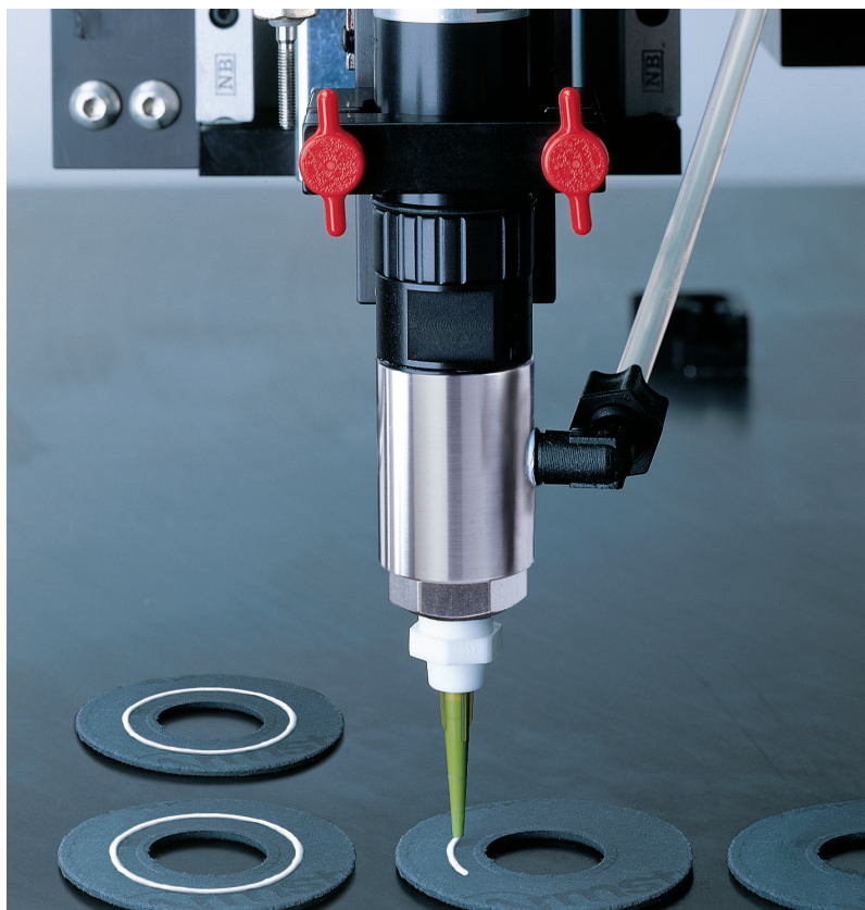
725DA dosifica líneas uniformes de adhesivo a base de agua.
