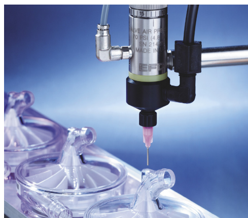
La valvola 752V applica adesivo a polimerizzazione UV su pompa per uso medico.
