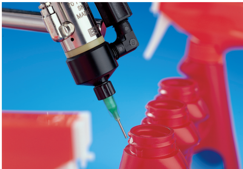
Ideale per la dosatura controllata di quasi tutti i fluidi di bassa e media viscosità.
