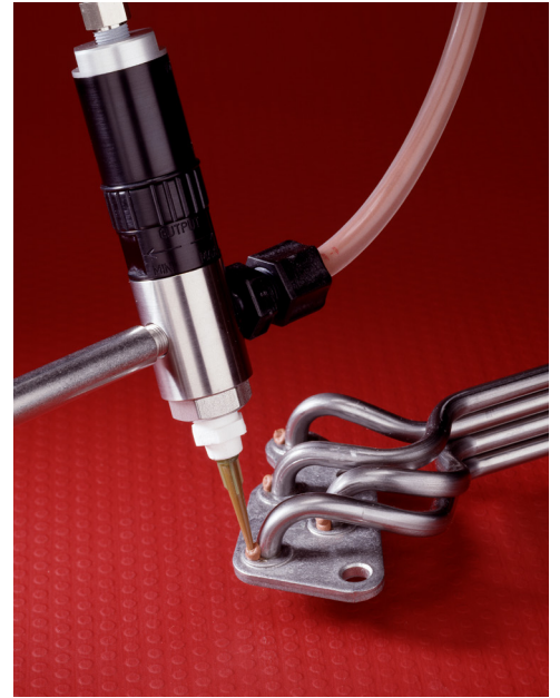
725D在汽车传动管上焊焊膏。
