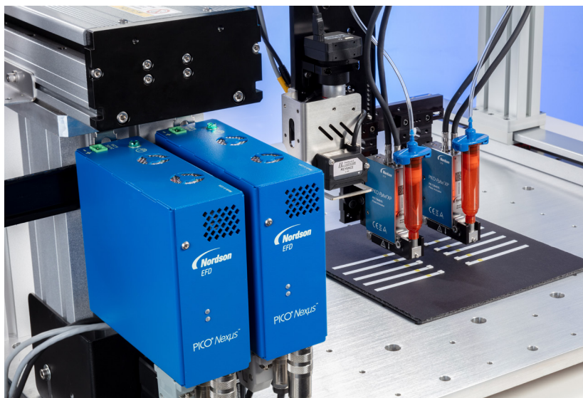
小型サイズのコントローラーは、複数台数でもDINレールへの取り付けが簡単です
