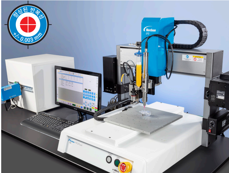
PROX 시리즈는 비접촉식 리니어 모터로 구동되어 작동 속도가 향상되고 유지보수 필요성이 감소합니다.
