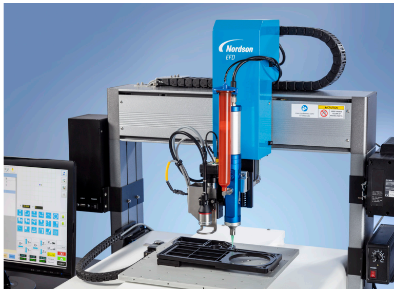
PROX 솔루션은 DispenseMotion 소프트웨어, 통합 비전 및 레이저 높이 감지, \pm 0.003\text{mm}/3\mu\text{m} 수준의 반복 정밀도를 제공합니다.
