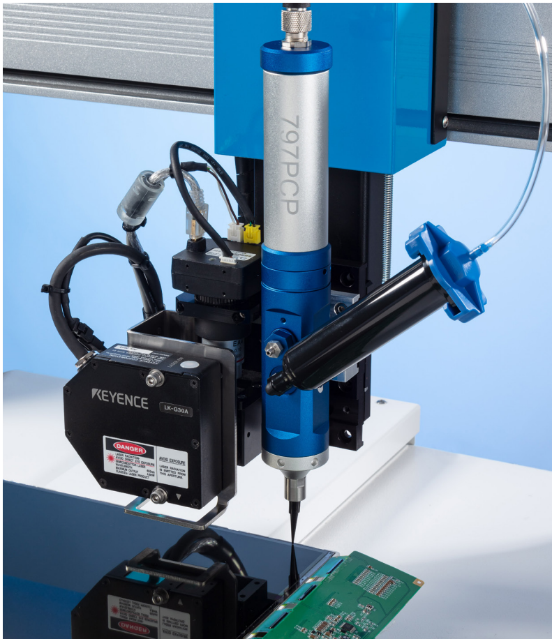
797PCP 渐进式螺杆阀提供行业领先的胶点精度和可重复性高达±1%。
