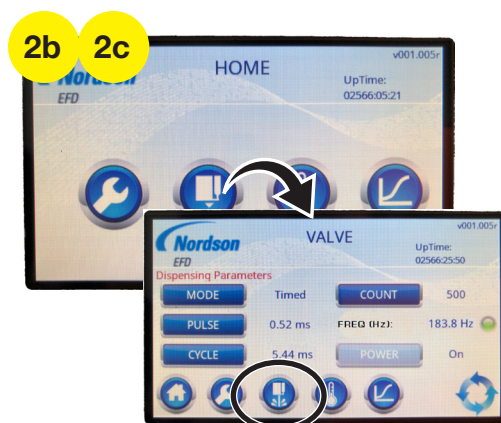
Emplacement de la touche PURGE (écran VALVE du contrôleur Touch standard illustré)
