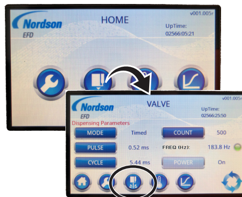
Emplacement de la touche PURGE (écran VALVE du contrôleur Touch standard illustré)
