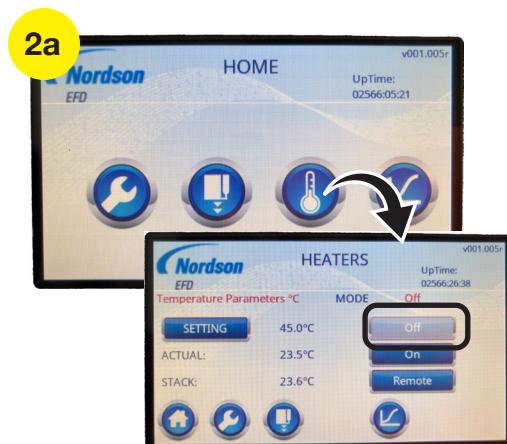
Désactivation du contrôle du dispositif de chauffe
