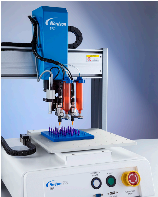
Dépose de colle UV sur des dispositifs médicaux à l'aide du robot EV.
