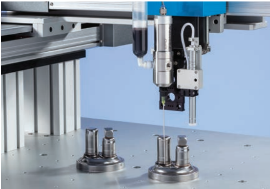
Das 736 Ventil dosiert Fett auf die Kraftstoffpumpenhaube.
