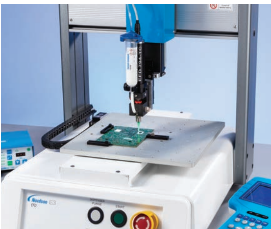
Das 794-TC Ventil ermöglicht präzise, wiederholbare Punkt- und Musterdosierungen von Wärmeleitmaterialien.
