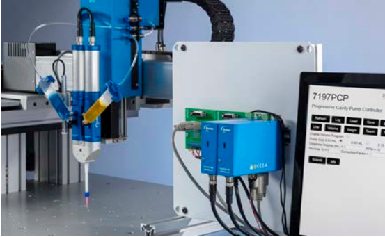
Die 797PCP-2K Exzentrerschneckenpumpen bieten klassenbeste Wiederholgenauigkeit des Dosiervolumens.
