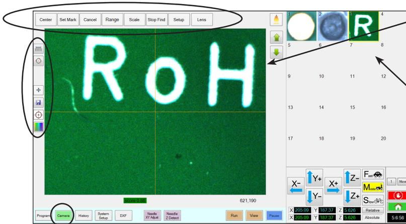
La pantalla Vista primaria muestra la vista real de la cámara cuando se selecciona la pestaña Cámara.
