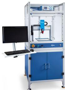
Los recintos de seguridad protectores Nordson EFD se integran de fácilmente en sus sistemas de dosificación automatizados. Equipados con controles de dosificación externos, una cortina de luz de seguridad y una caja de control eléctrica interna y pasos para cables para una instalación más rápida y segura, estos recintos Certificados CE también cumplen la directiva de la UE en materia de maquinaria 2006/42/CE.
