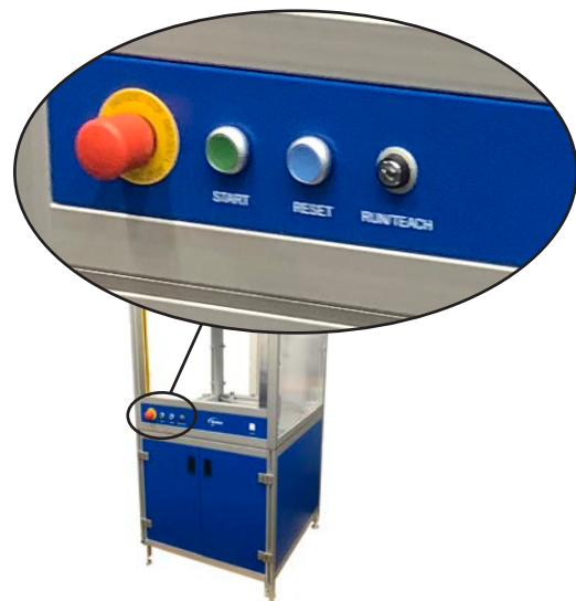
Controles en la parte frontal de un recinto de seguridad UE
