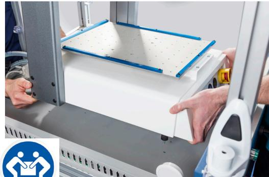
7. Abra las puertas del recinto y use una llave abierta para instalar las tuercas M5 retiradas previamente, fijando así el robot al recinto.
