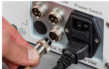
4. Conecte el cable de entrada/salida (E/S) al puerto de E/S.
