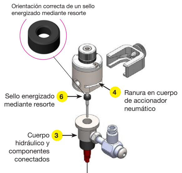
Cambio de cuerpo hidráulico de una válvula con sello energizado mediante resorte
