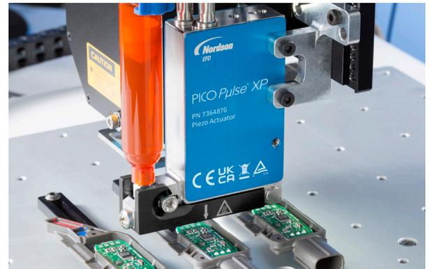
Die kontinuierliche Anpassung des Hubs von PICO *Pulse* XP sorgt für eine dauerhafte Wiederholgenauigkeit der Dosierung.
