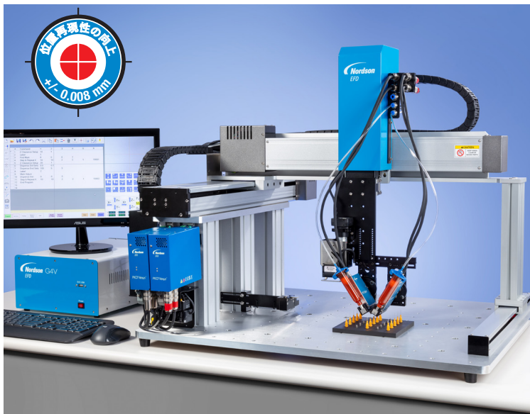
GVPlusシリーズは、デュアルマウントフランジと追加アームサポートにより、振動を低減し、スルーputを改善します
