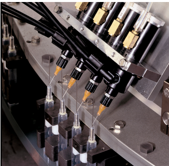
Las válvulas 741V dispensan curado UV en una plato giratorio de producción médica.
