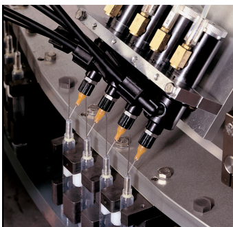
Las válvulas 741V dispensan curado UV en una plato giratorio de producción médica.
