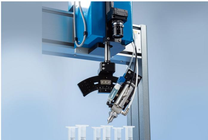
Die Smart-Vision-CCD-Kamera prüft das Vorhandensein des Werkstücks.
