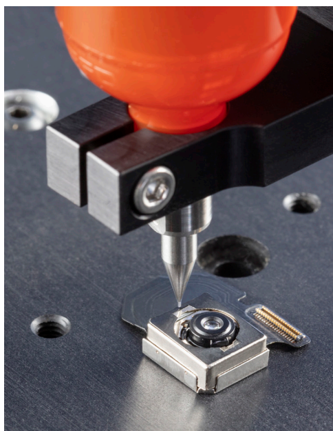
Dosatura di micro depositi su modulo per fotocamera compatta.
