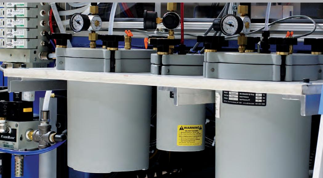
I serbatoi per fluidi EFD mantengono stabile la pressione del fluido, ne prevengono la contaminazione e l'evaporazione e svolgono un'operazione di contenimento dei fumi. I serbatoi sono dotati di regolatori aria costante da 0-1,0 bar o 0-7,0 bar per la gestione delle diverse viscosità dei fluidi.
