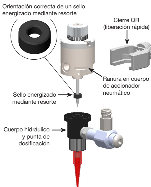
Cambio de cuerpo hidráulico de una válvula con sello energizado mediante resorte
