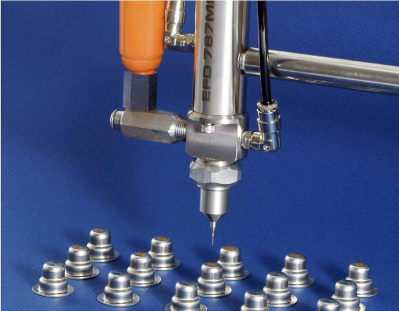
Aplique un patrón de pulverización preciso y uniforme de un 30 % más pequeño que las válvulas de pulverización estándar.
