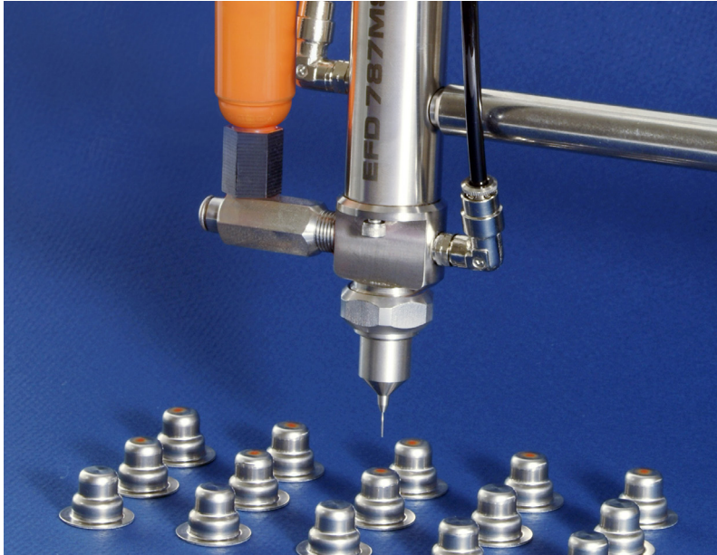
与标准喷雾阀相比，喷涂面积缩小了30%，能够实现精密、一致的喷涂。
