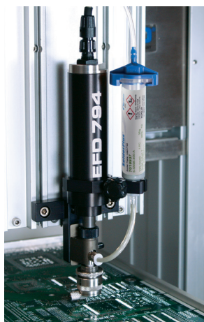
La valvola a coclea 794 dosa pasta SolderPlus di Nordson EFD su un circuito stampato.
