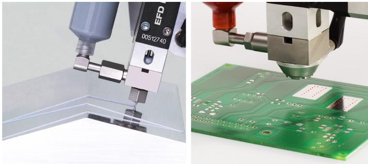
비접촉 마이크로 분사 시스템은 접근하기 어렵거나 정교한 표면에 비드(방울)와 충전제를 간편하게 분사할 수 있고 연속 작동이 가능합니다.
