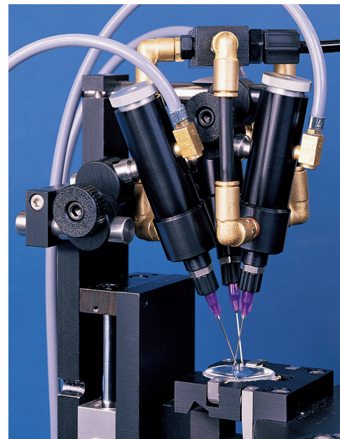
Les valves 741V déposent des points d'adhésif UV sur la lentille du lecteur de code.
