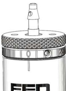
Le zéro (0) et la marque de repérage sont alignés, indiquant que la bague graduée est correctement calibrée.
