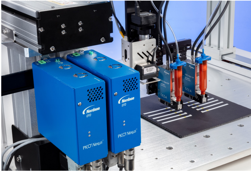
Son petit format facilite le montage de plusieurs contrôleurs sur un rail DIN.
