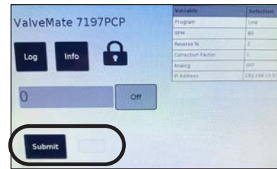
Schermata Main (Principale) quando la funzione di blocco / sblocco è abilitata e il sistema è bloccato; è richiesta una password
