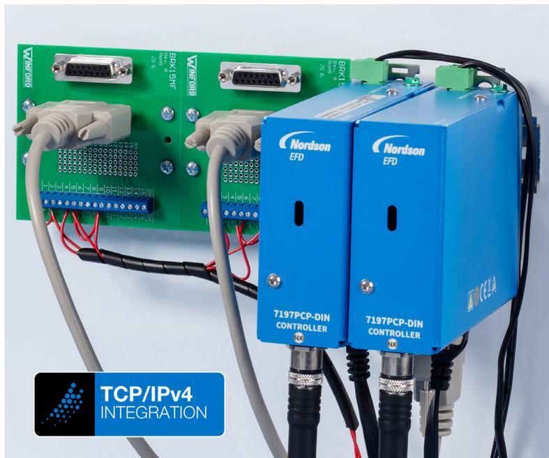
Der 7197PCP-DIN-NX Controller umfasst das NX-Protokoll über Ethernet für die Smart Factory-Integration.
