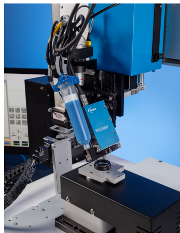
Ein fester Kopf sorgt für weniger Verschleiß durch den Drehtisch.
