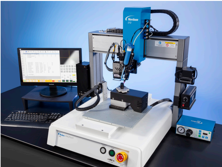
Der abnehmbare Drehtisch ermöglicht sowohl 4-Achsen- als auch 3-Achsen-Anwendungen.
