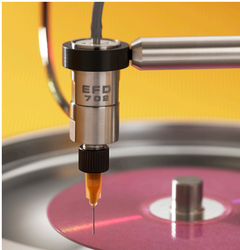
Rivestimento e incollaggio controllato e uniforme per i supporti ottici.
